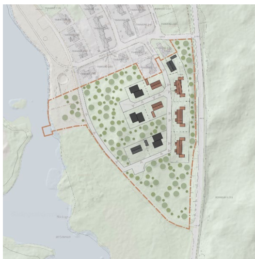
Exempel 2 Illustrationsplan (ej skalenlig) över föreslagen struktur. Styckningslotterna för enbostadshusen är ca. 900 kvm. I illustrationsplanen upptar respektive huvudbyggnad 170-300 kvm (komplementbyggnader har tilldelats vissa styckningslotter och dessa varierar i storlek mellan 40-100 kvm). Styckningslotterna för tvåbostadshusen är ca. 1500 kvm. I illustrationsplanen upptar respektive huvudbyggnad 340 kvm. Pilarna visar möjlig placering av entré.
