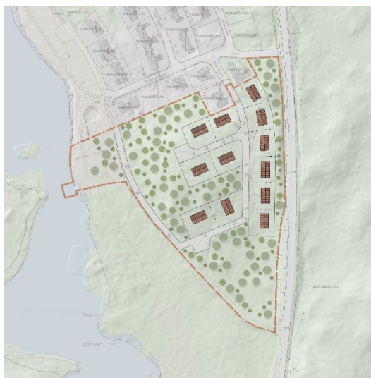
Exempel 1 Illustrationsplan (ej skalenlig) över föreslagen struktur. Styckningslotterna för enbostadshusen är ca. 900 kvm. I illustrationsplanen upptar respektive huvudbyggnad 170 kvm byggnadsarea. Pilarna visar möjlig placering av entré.
