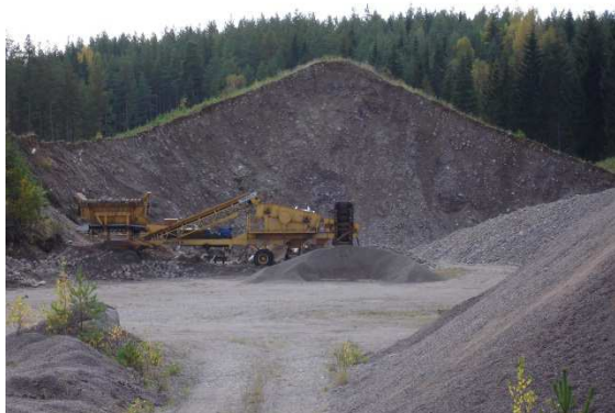
En täkt i norra änden av Bastebergs åsnät där man ser en åsrygg i genomskärning. Stenarna har slipats mot varandra och materialet är ganska osorterat i olika storlekar.
